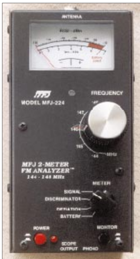
Frontansicht des MFJ-224. Das Meßinstrument trägt Skalen für den Eingangspegel mit einem Meßumfang von 60 dB in einem Bereich, für den Hub bis 7 kHz und die Trägermitteneinstellung sowie eine Markierung für den Batteriezustand.
