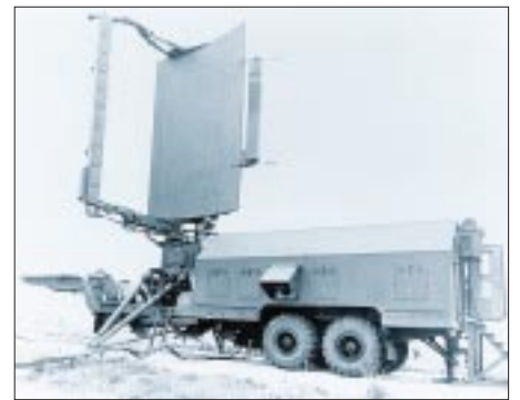
Störgeschützte, mobile 3-D-Funkmeßstation ST-68U, die die Warschauer Vertragsstaaten in den 80er Jahren zur Ortung von Cruise Missiles einführt.
