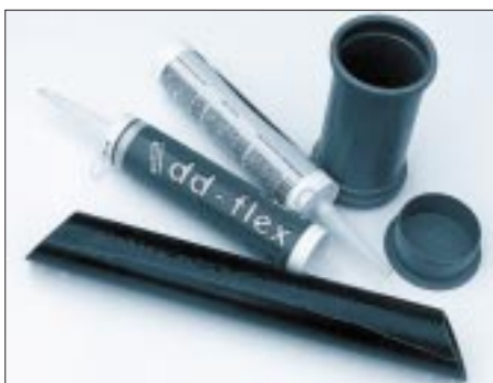
Bild 2: Verschiedene Materialien zur Herstellung von Luftspulen. Im Vordergrund das im Text angesprochene Epoxidrohr.
