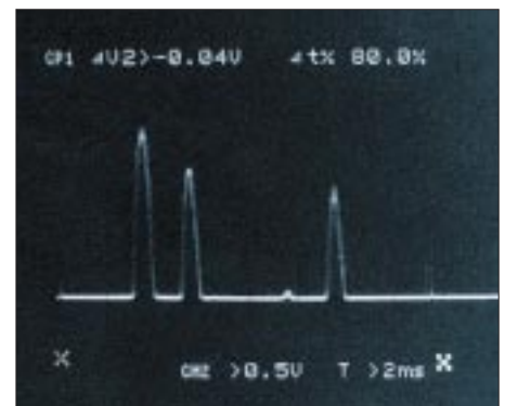
Bild 24: Oszi 40 MHz. Bereich gespreizt. Zwischen Tracking-Generator und HF-Eingang ein Schwingkreis 2 MHz. Die beiden kleineren Peaks sind Marken 2,5 MHz.
