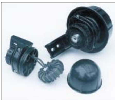
Bild 3: Die Übergangsköpfe IP 31 im Vertrieb der Firma Oppermann eignen sich gut, um Ferrit-Ringkerne wetterfest unterzubringen. Beim größeren Bauteil ist der Koaxialkabelanschluß in Form einer eingebauten SO-Buchse zu sehen. Fotos: Autor
